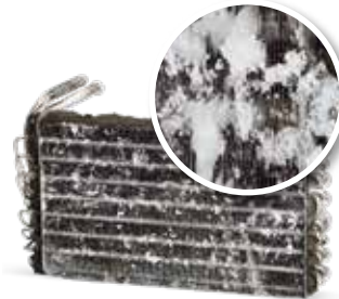
Χωρίς συντήρηση του συστήματος κλιματισμού
