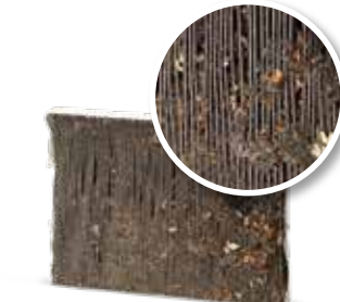
Χωρίς συντήρηση του συστήματος κλιματισμού
