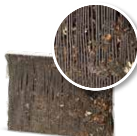
Sem manutenção do ar-condicionado
