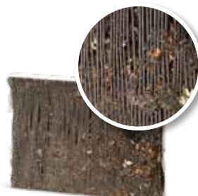
Climatizzatore non sottoposto a manutenzione
