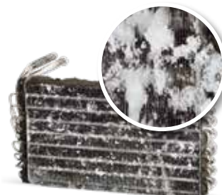
Climatizzatore non sottoposto a manutenzione
