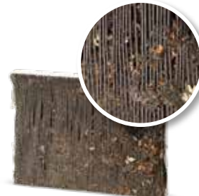
Sin mantenimiento de la climatización
