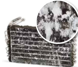
Sin mantenimiento de la climatización
