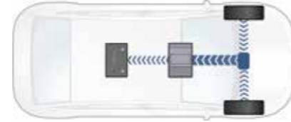
Frenleme yapan araç - akünün artan gücü ile şarj edilmesi
