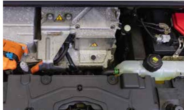
Komponenty wysokiego napięcia w komorze silnika
