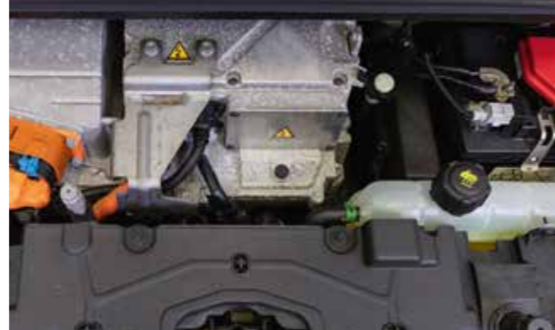
Componentes de alta tensión en el compartimento del motor
