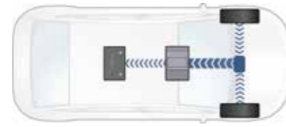
Abbremsendes Fahrzeug – Ladung der Batterie mit erhöhter Leistung
