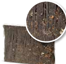
Без технического обслуживания кондиционера
