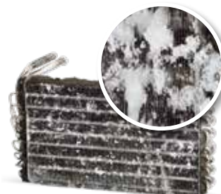
Sem manutenção do ar-condicionado
