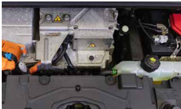
Composants haute tension du compartiment moteur
