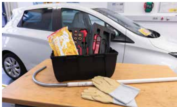
Outillage pour les interventions sur le système haute tension
