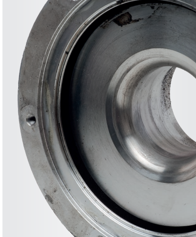
Resim 2: Kompresör gövdesinde temas izleri
