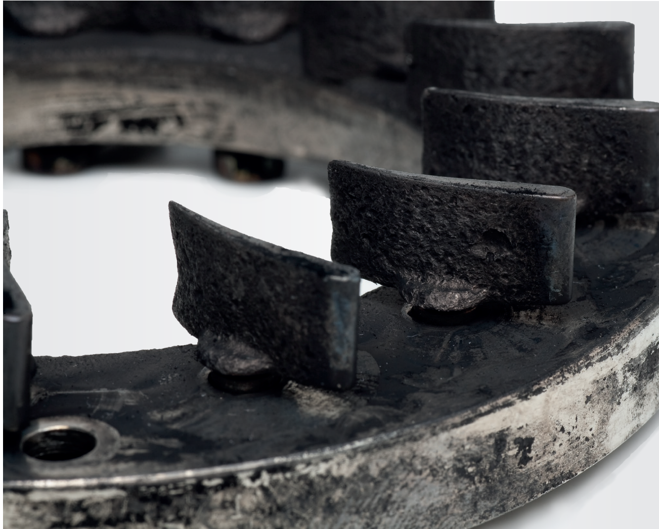
Resim 1 VTG ünitesinin hasarlı hava yönlendirme plakaları
