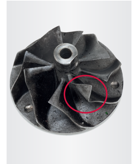
Resim 4 Kompresör çarkının sadece bir kanatçığı hasar görmüş
