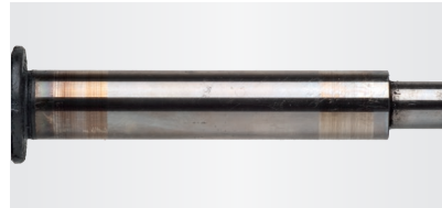
Resim 4: Mil üzerine yapılmış yatak malzemesi
