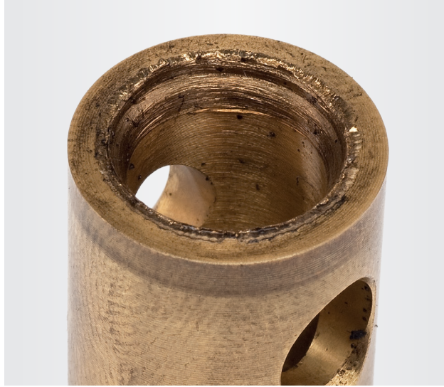
Resim 1 Radyal yatakta çizik izleri
