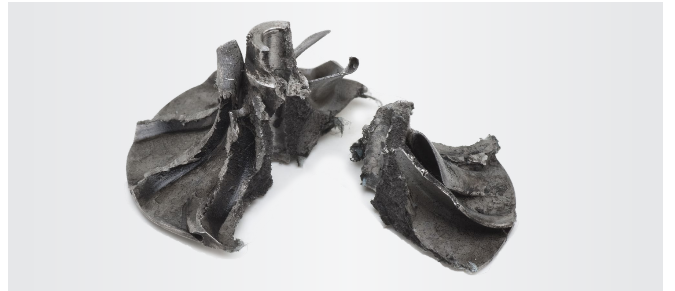
Resim 2 Tamamen parçalanmış kompresör çarkı
