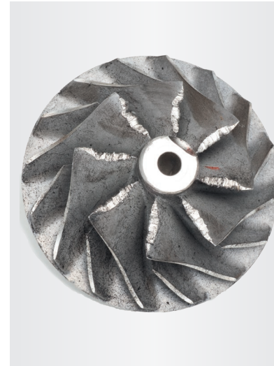
Resim 2 Yabancı maddeler yüzünden hasar görmüş kompresör çarkı
