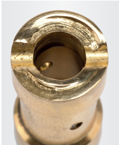
Resim 6: Yamulmuş yatak burcu
