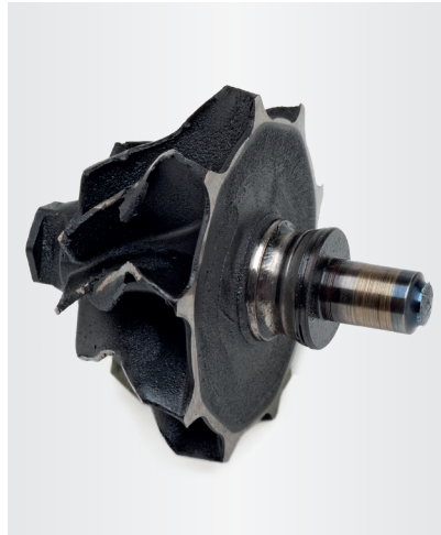
Resim 5: Kırık mil gövdesi
