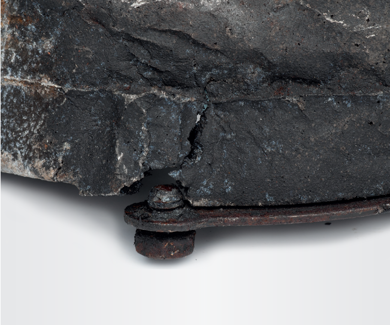
Resim 1 Türbin gövdesinde çatlak
