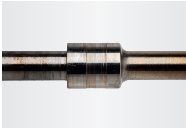
Resim 4 Mil üzerindeki yatak noktalarında belirgin aşınma izleri
