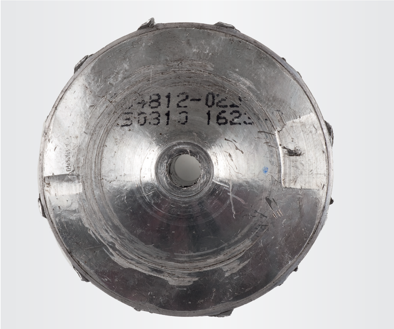
Resim 1 Kompresör çarkının arka kısmında çukurlar
