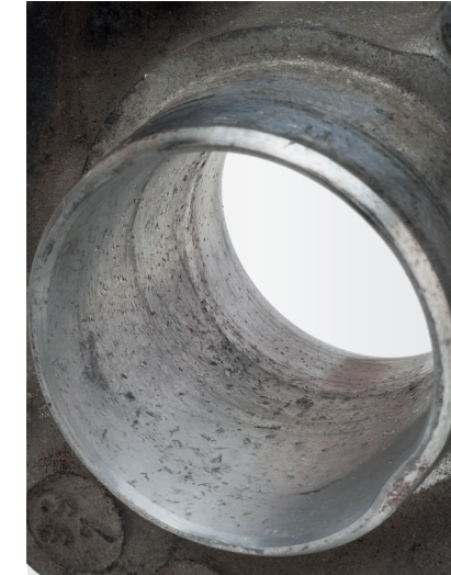
Resim 3 Kompresör gövdesinin emme kanalında yabancı madde darbeleri
