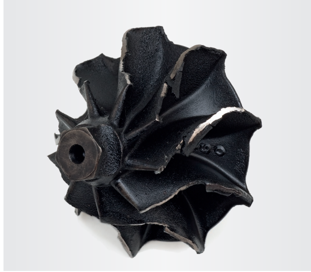
Resim 2 Gövde muhafazasına sürtmüş türbin çarkı
