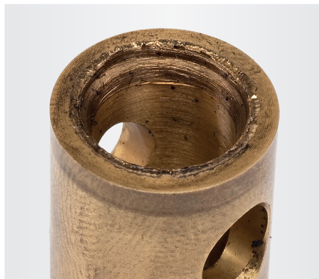
Fig. 1 Estrías en el cojinete radial
