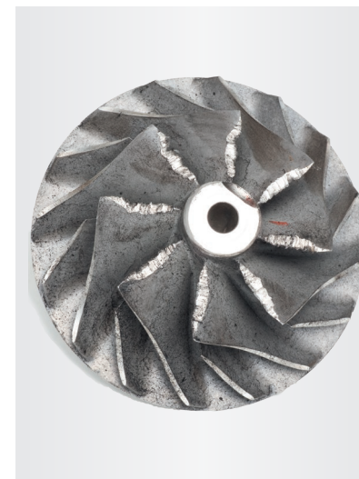
Fig. 2 Rueda de compresor dañada debido a partículas extrañas
