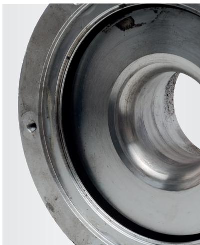
Fig. 2: Marcas por roce en la carcasa del compresor
