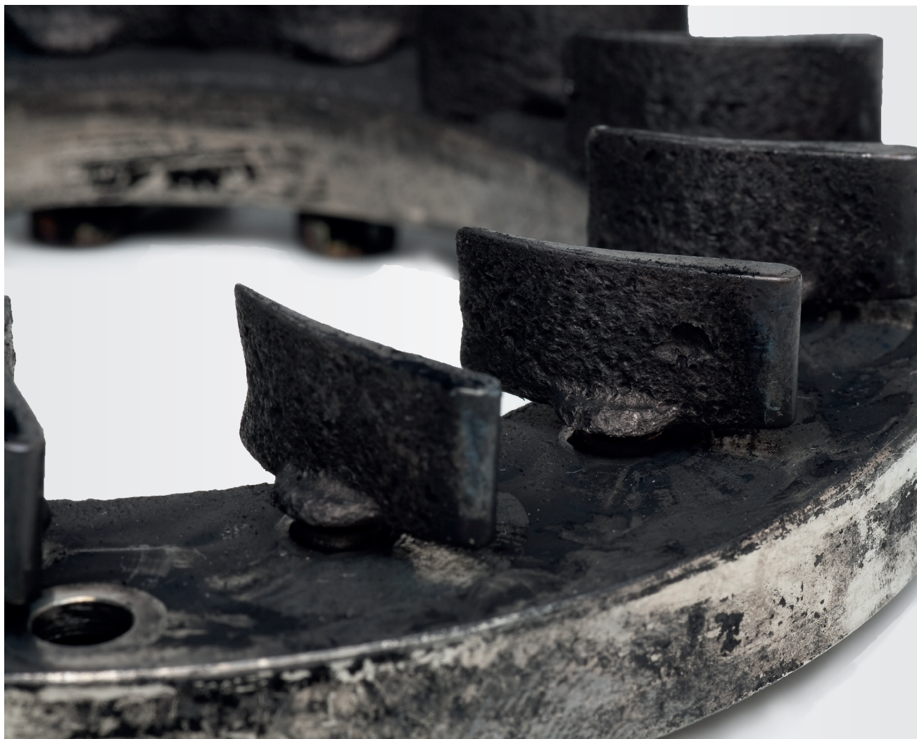
Fig. 1 Álabes del turbo de geometría variable dañados
