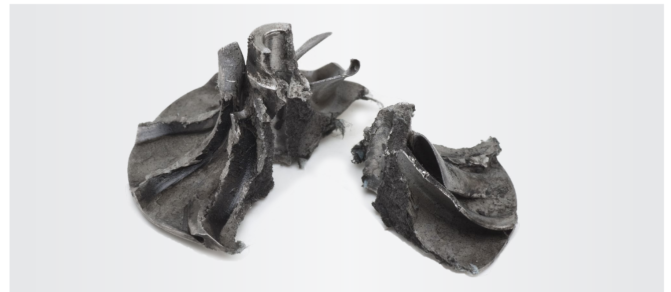
Fig. 2 Rueda del compresor partida
