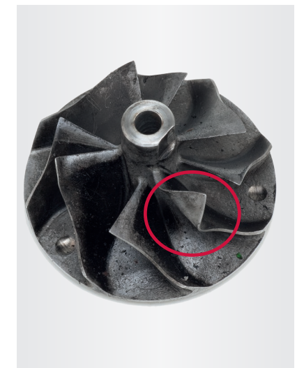
Fig. 4 Solo una aleta de la rueda del compresor dañada
