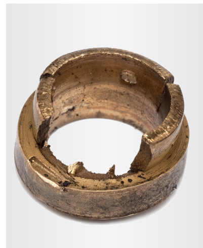
Fig. 7: Cojinete radial roto
