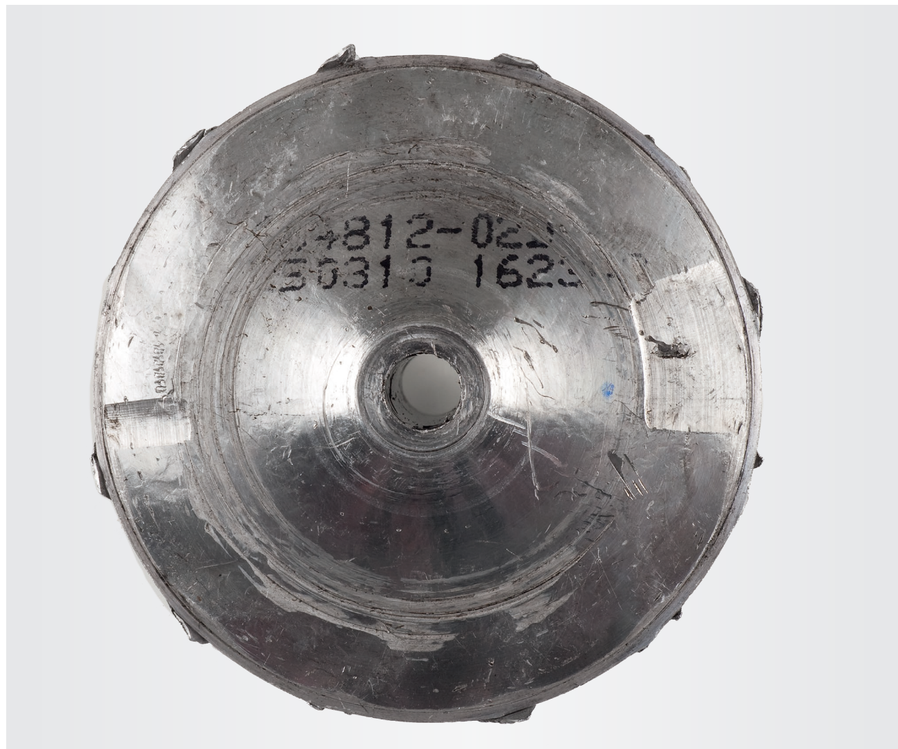
Fig. 1 Abolladuras en el lado trasero de la rueda del compresor
