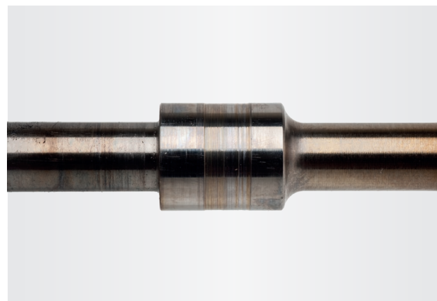
Fig. 4 Marcas patentes de desgaste en el punto del cojinete sobre el eje
