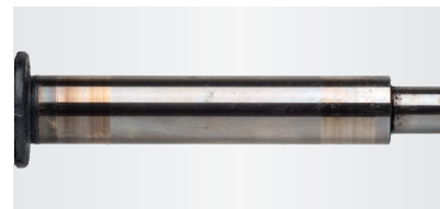
Fig. 4: Material de cojinete soldado sobre el eje
