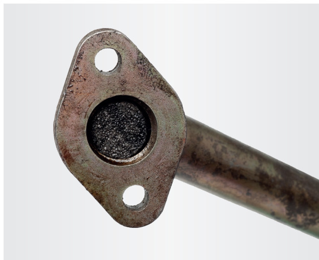
Fig. 1 Conducto de retorno de aceite carbonizado
