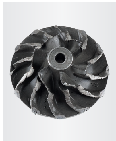
Fig. 1: Rueda de compresor que roza en la carcasa
