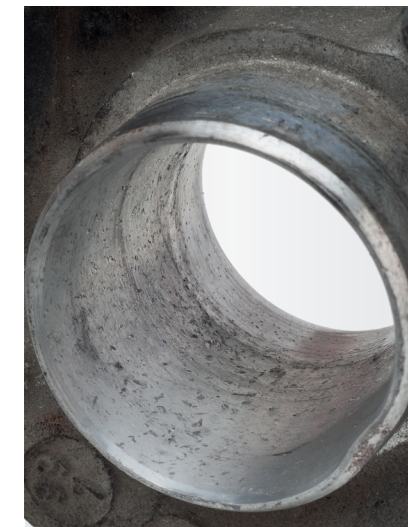
Fig. 3 Impactos de partículas extrañas en el canal de admisión de la carcasa del compresor
