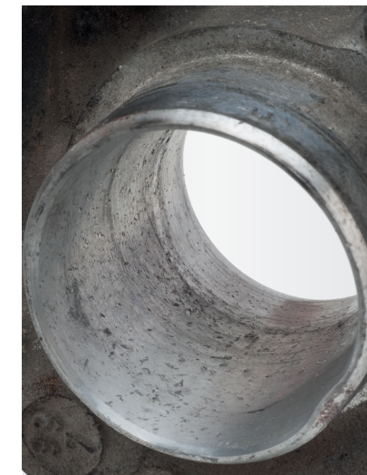
Abb. 3 Fremdkörpereinschläge im Ansaugkanal des Verdichtergehäuses
