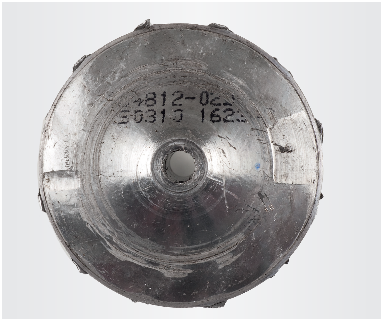
Abb. 1 Dellen auf der Rückseite des Verdichterrads
