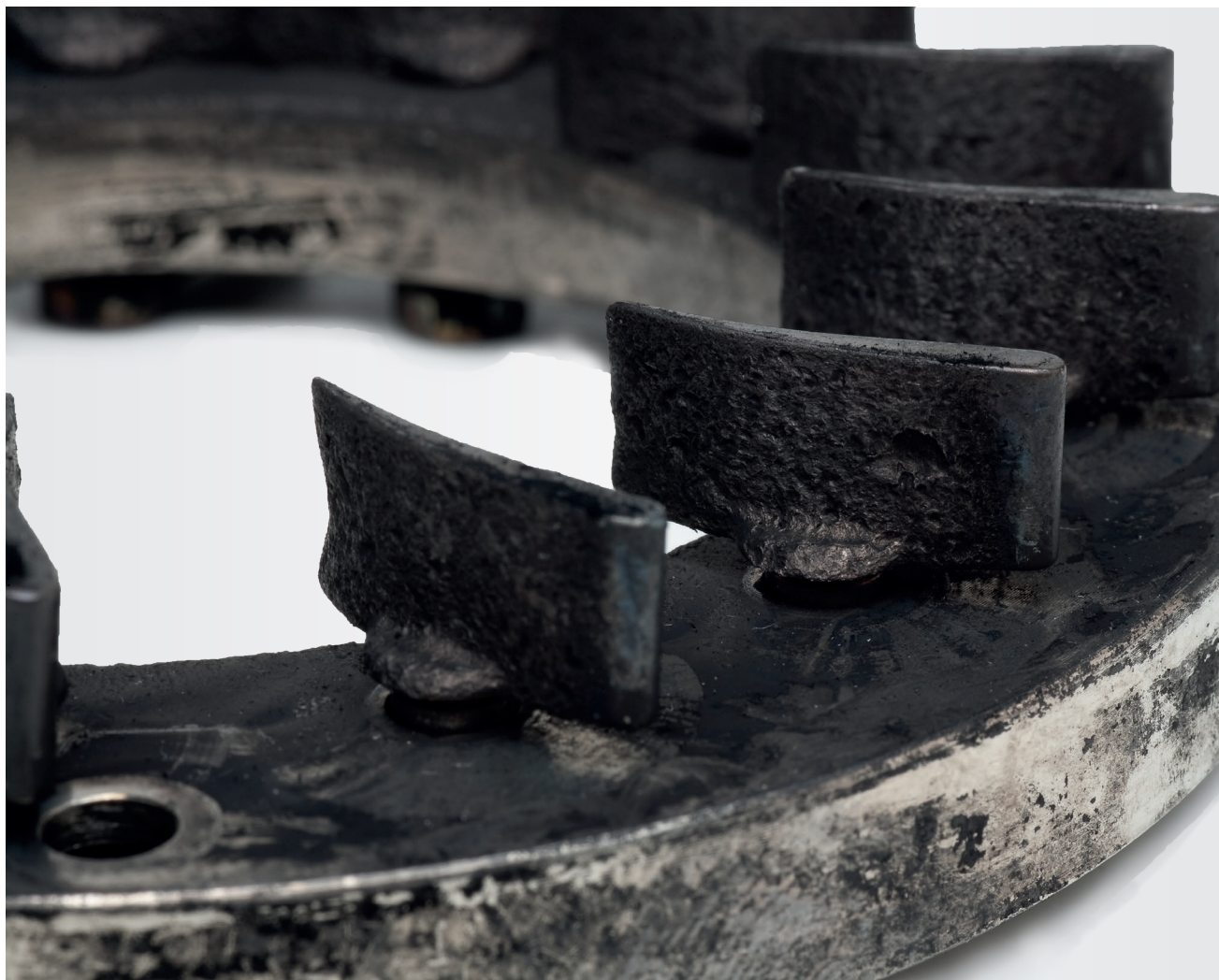
Abb. 1 Beschädigte Luftleitbleche der VTG-Einheit
