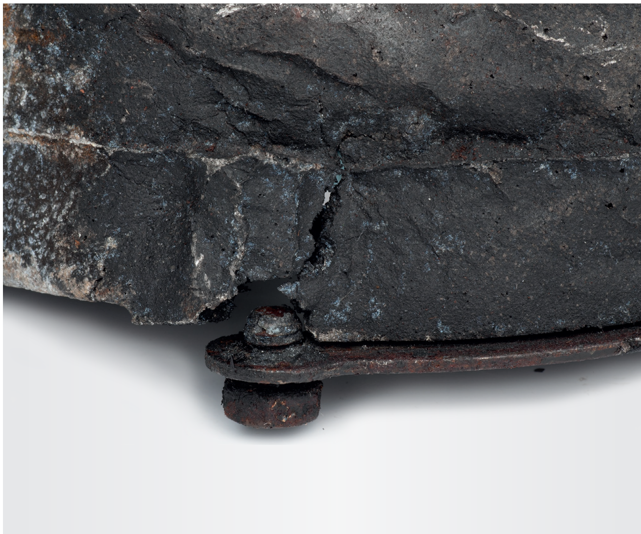
Abb. 1 Riss im Turbinengehäuse
