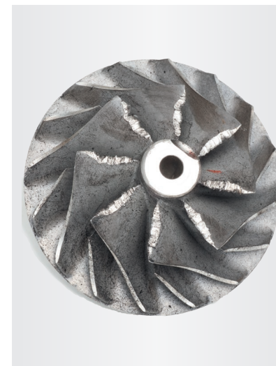
Abb. 2 Durch Fremdkörper beschädigtes Verdichterrad
