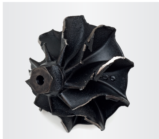
Abb. 2 An das Gehäuse angelaufenes Turbinenrad
