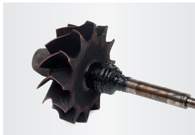
Abb. 3 Verkoktes Öl auf der Turbinenseite
