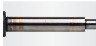
Abb. 4: Auf die Welle aufgeschweißtes Lagermaterial
