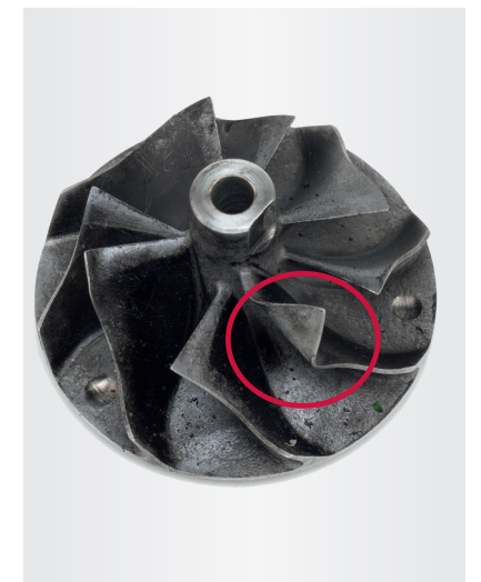
Abb. 4 Nur eine Fahne des Verdichterrads beschädigt
