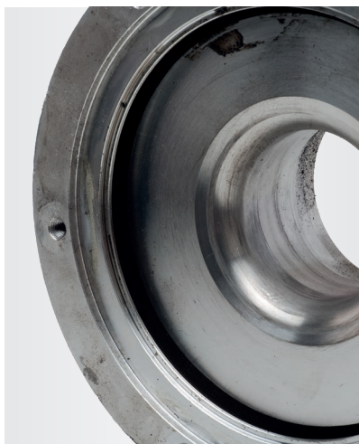
Abb. 2: Anlaufspuren im Verdichtergehäuse
