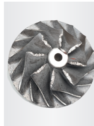
Ilustracja 2 Wirnik sprężarki, uszkodzony przez ciała obce
