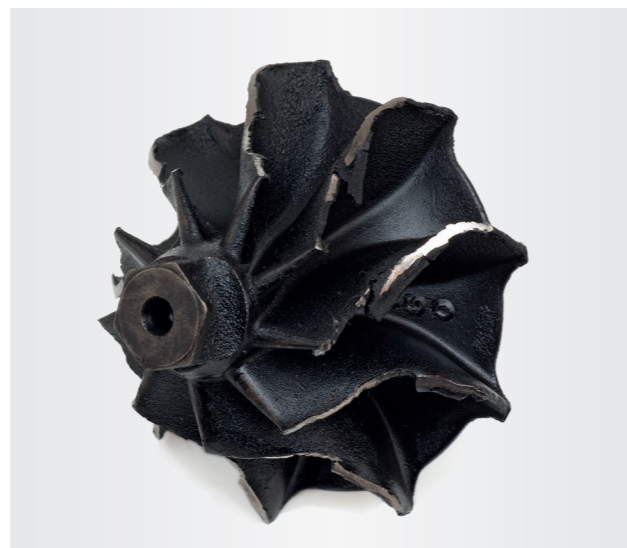
Ilustracja 2 Wirnik turbiny po otarciu się o korpus
