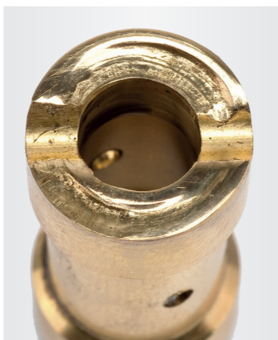
Ilustracja 6: Skręcona tulejka łożyskowa
