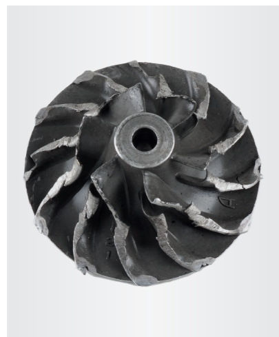
Ilustracja 1: Wirnik sprężarki po uderzeniu w korpus
