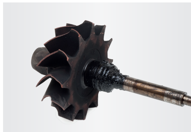
Ilustracja 3 Nagar olejowy po stronie turbiny
