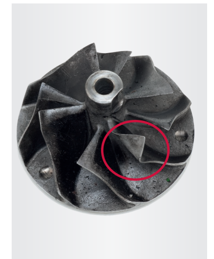
Ilustracja 4 Uszkodzona tylko jedna łopata wirnika sprężarki
