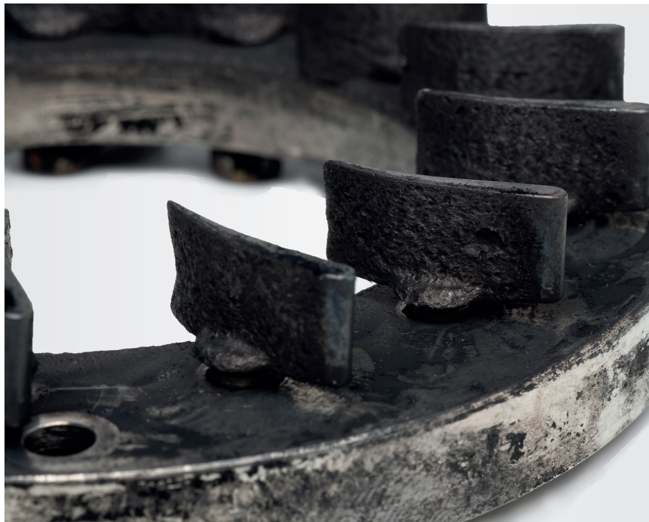
Ilustracja 1 Uszkodzone kierownice powietrza w zespole VTG
