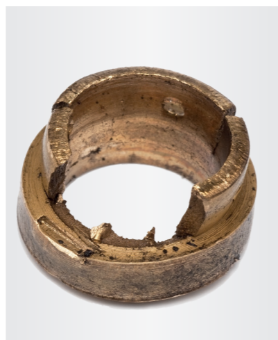
Ilustracja 7: Zniszczone łożysko promieniowe
