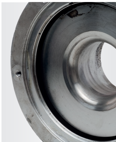
Ilustracja 2: Ślady tarcia w korpusie sprężarki
