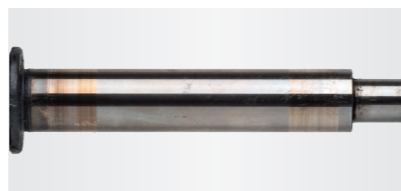
Ilustracja 4: Napawany na wale materiał łożyska
