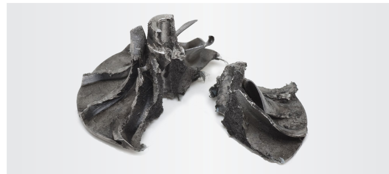
Ilustracja 2 Rozerwany wirnik sprężarki
