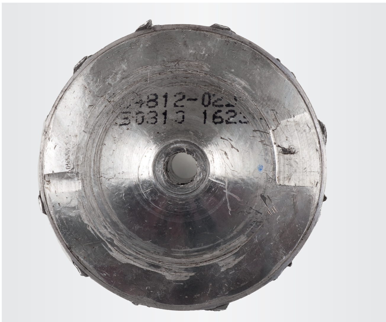
Ilustracja 1 Wgniecenia od tyłu wirnika sprężarki
