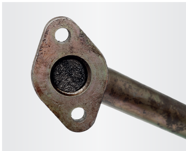
Ilustracja 1 Przewód powrotny oleju, zanieczyszczony nagarem
