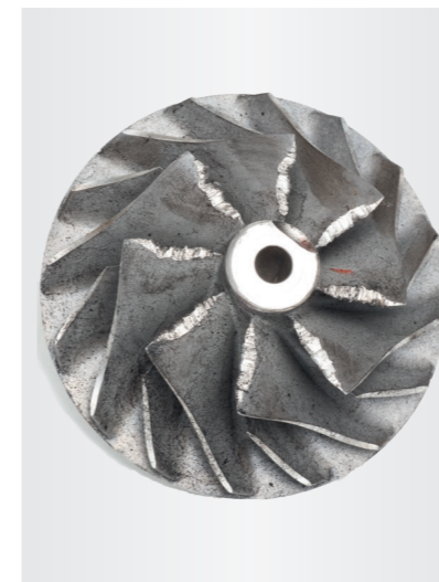
Fig. 2 Roue du compresseur endommagée par des corps étrangers
