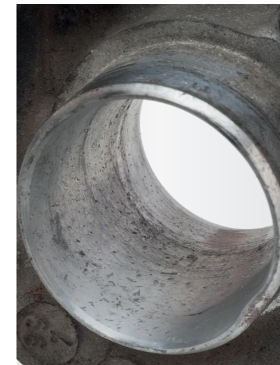
Fig. 3 Impacts de corps étrangers dans le canal d'admission du carter du compresseur
