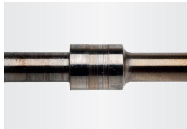
Fig. 4 Traces d'usure évidentes de l'arbre sur les surfaces de paliers
