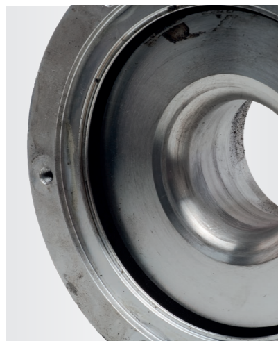
Fig. 2 : Traces de friction dans le carter du compresseur
