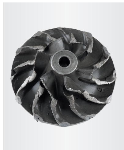
Fig. 1 : Roue de compresseur ayant heurté le carter
