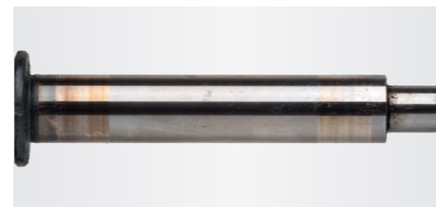
Fig. 4 : Matériau du palier soudé sur l'arbre
