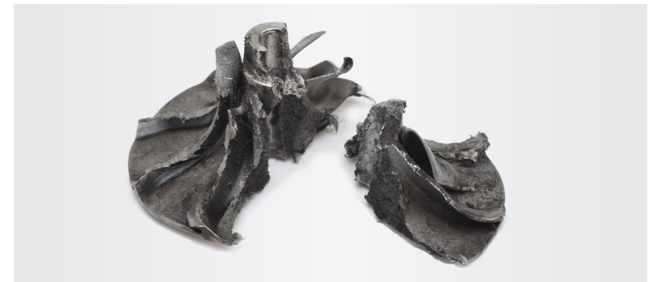
Fig. 2 Roue de compresseur cassée
