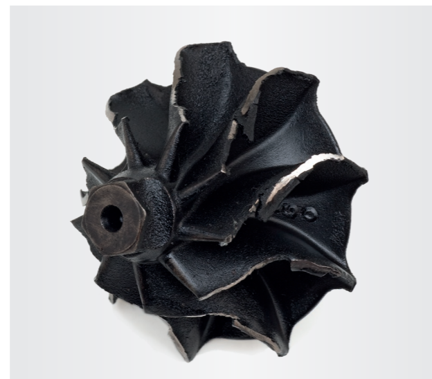
Fig. 2 Roue de turbine ayant heurté le carter
