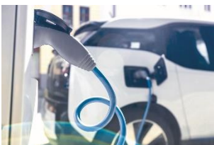
Direkter Draht: Die neue MAHLE Batteriediagnose steuert die Batterie direkt über den Ladestecker an.
