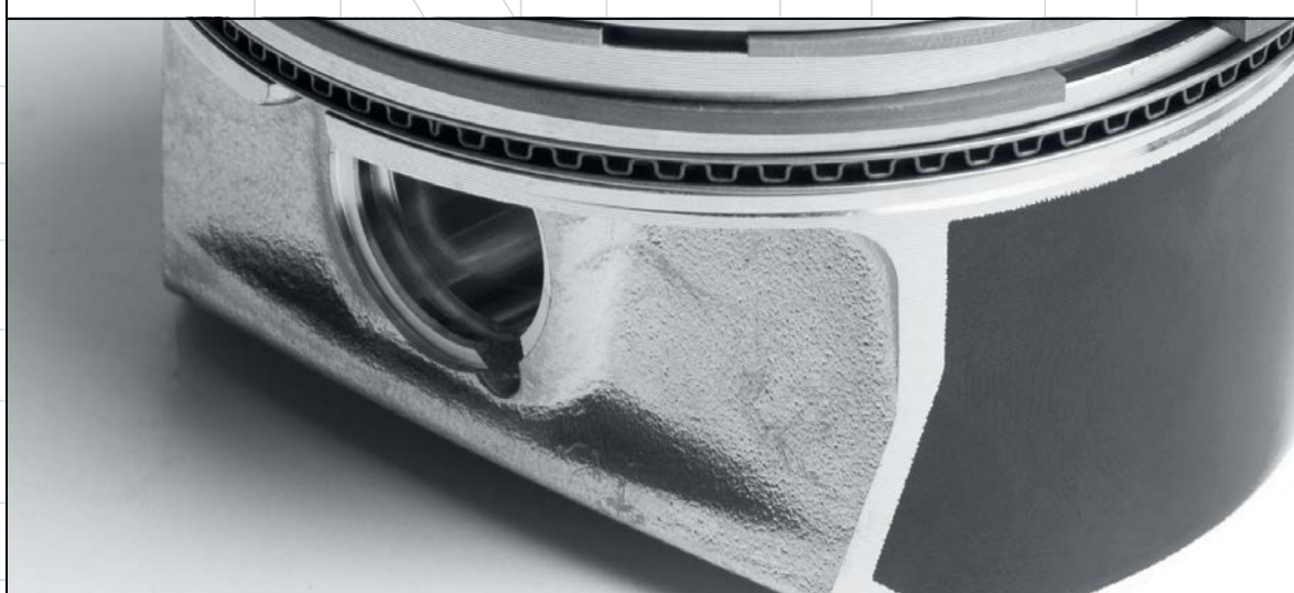
Das ECOFORM®-Kolbenkonzept: Eine von MAHLE entwickelte Gießtechnologie in Bolzenrichtung ermöglicht sehr große Hintergießungen der Ringpartie und somit eine deutliche Verringerung des Kolbengewichts.
