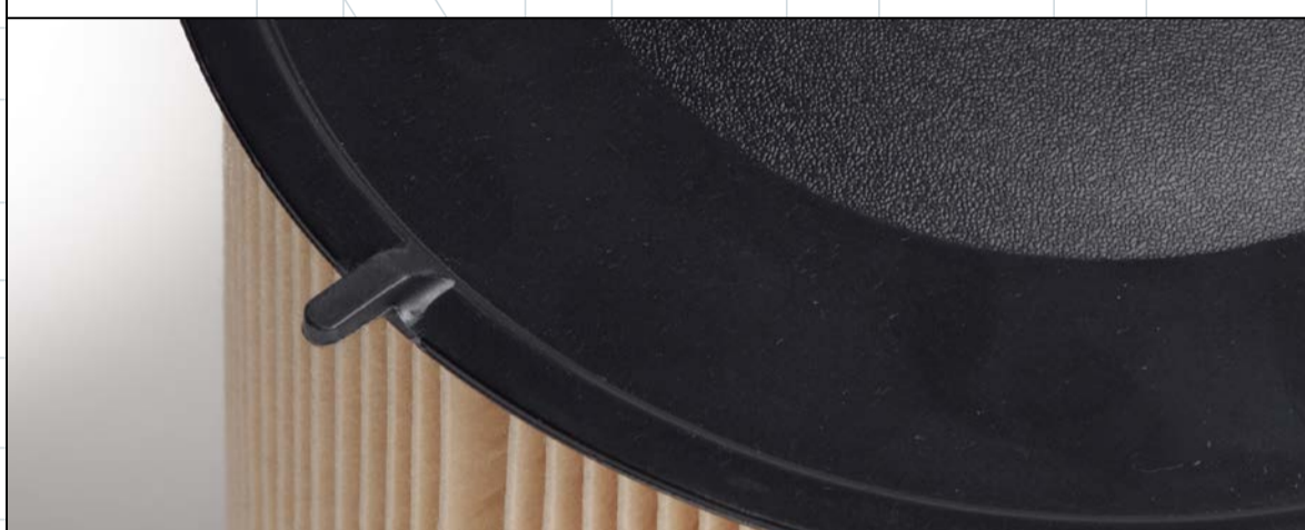
Von MAHLE entwickelte Ausrichtkontur an der Endscheibe des Luftfilter-Einsatzes: Passt exakt auf die Ausrichtgegenkontur des Filtergehäuses und gewährleistet damit die korrekte Drehlage des Filterelements und somit eine zuverlässige Luftmassenmessung.
