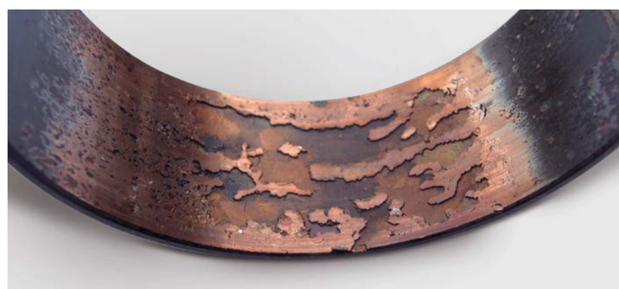
Ölverdünnung durch zu niedrige Motortemperaturen. Die Folge: Pleuellagerschaden.
