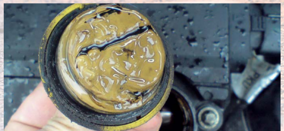
Alarmzeichen: gelblicher Schleim am Öldeckel – ein Hinweis auf Kondensate im Motoröl.
