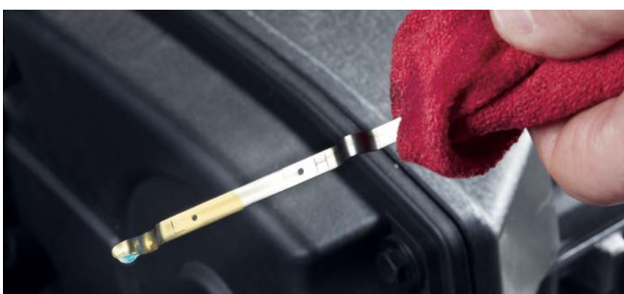
Wasser im Motoröl zeigt sich auch am Ölmesstab.
