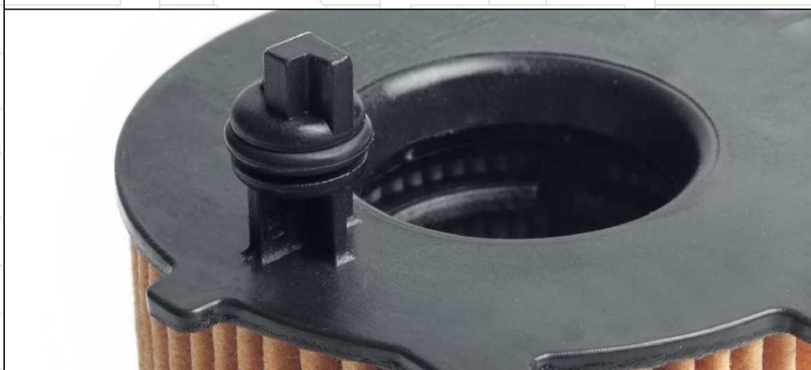
Patentierete MAHLE Technologie zum korrekten und unkomplizierten Filterwechsel durch das Zusammenspiel von Filtergehäuse und Filterelement. Der „PIN“ gleitet beim Wechsel passgenau in die für ihn vorgesehene Öffnung im Gehäuse und garantiert damit Dichtheit und sauberen Ölfilterwechsel.
